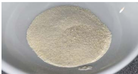
Harnstein nach Dokumentation von Anzahl, Trocknung und Zermahlung zur Vorbereitung für die Infrarotspektro- metrie-Untersuchung
